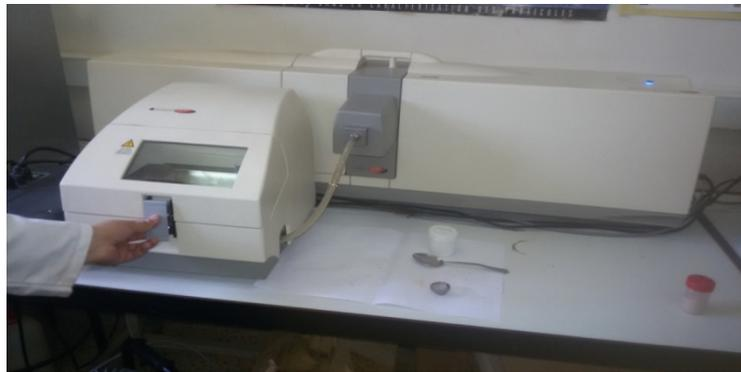
Figure II-18 appareil pour analyse granulométrique par laser
