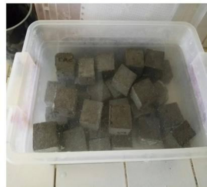
**Figure II-12****Conservation des éprouvettes
