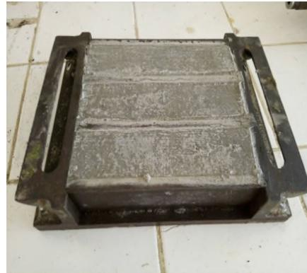
**Figure II-10****Moulage des éprouvette de mortier**
