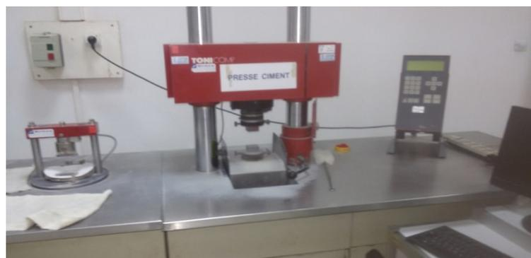
**Figure II-17 Machine d'essai de résistance a la compression**
