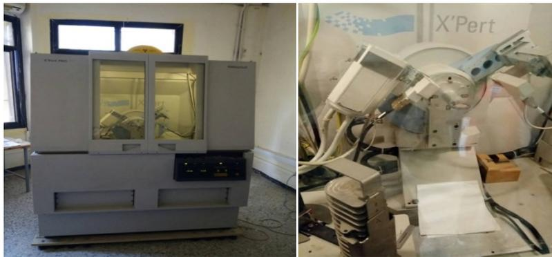
**Figure II-13 Diffractomètre par rayon X**
