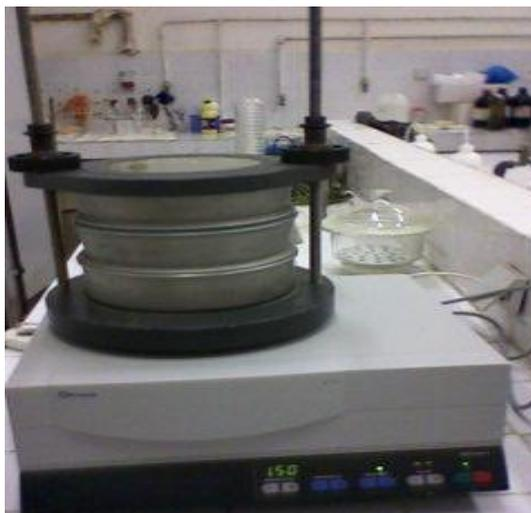
**Figure 6 :** Tamiseur électrique.
