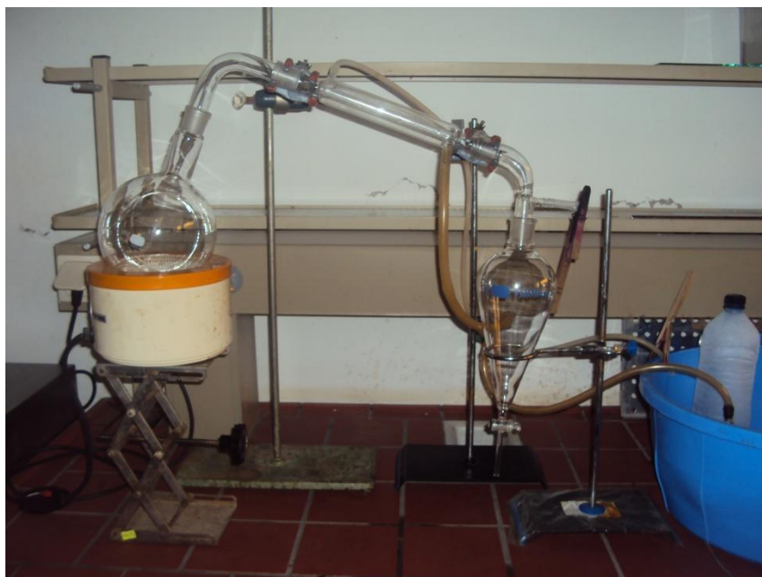
Figure 5 : Montage utilisé pour l'hydrodistillation
