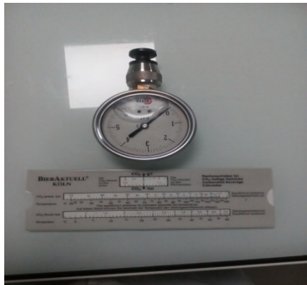
Manomètre et échelle de CO 2
