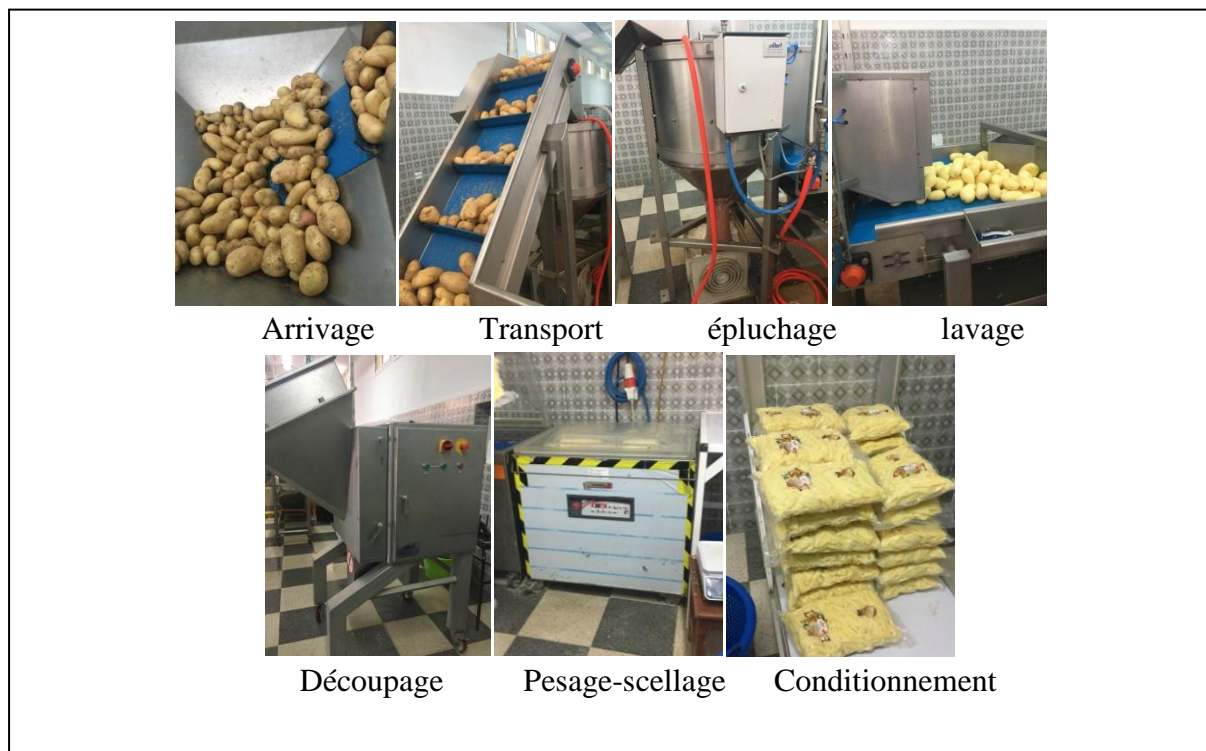
Figure 8 : Procédé de fabrication des frites industrielles
