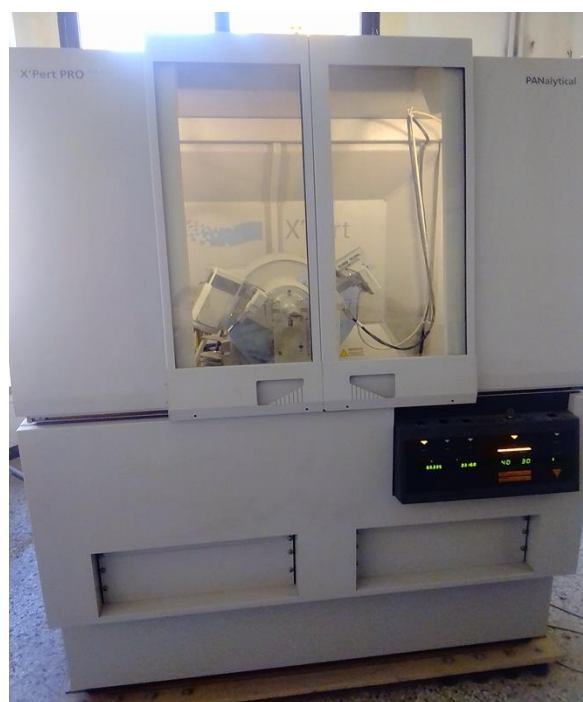
Figure II. 19 : Appareil de DRX de l'université de Bejaia
