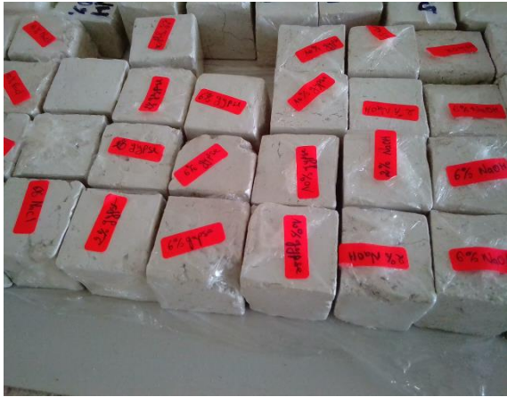
Figure II. 12 : Echantillons de 4 \times 4 \times 4 \text{ cm}^3 couverts avec du papier transparent
