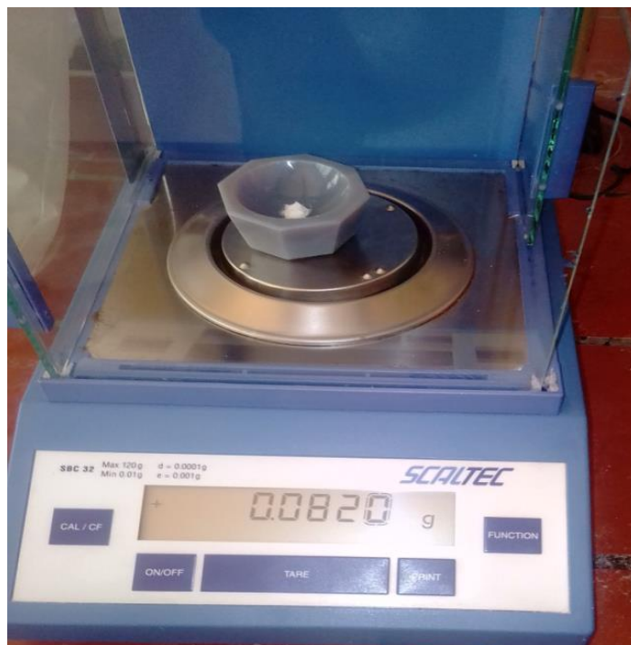
Figure II. 23 : KBr + poudre a testé pesés avec une balance de 0.0001g pré
