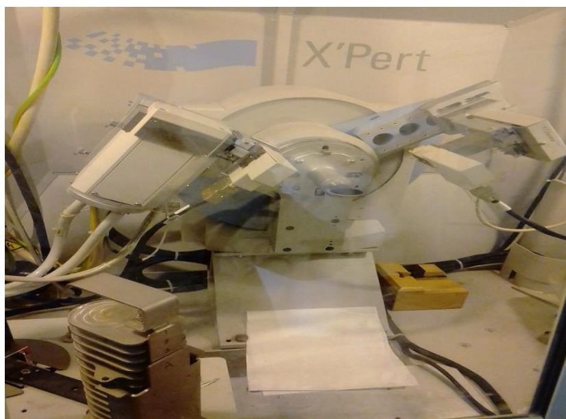
Figure II. 21 : le système rotatif projecteur des rayons X
