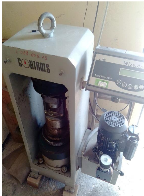
Figure II. 13 : Presse de compression à béton avec mécanisme spéciale pour échantillons cubiques 4 \times 4 \times 4 \text{ cm}^3 .
