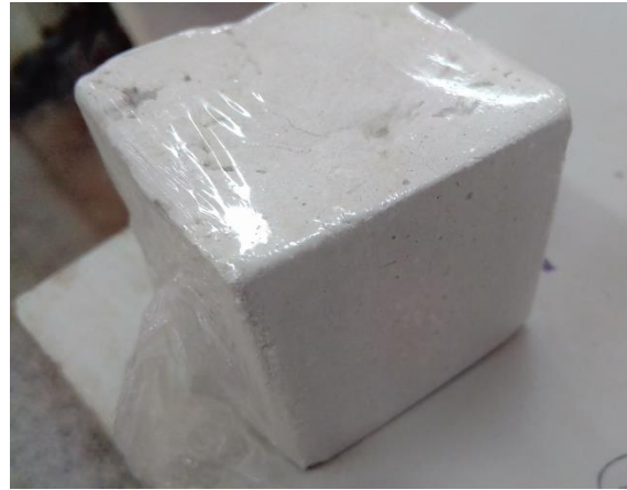
Figure II. 12 : Echantillons de 4 \times 4 \times 4 \text{ cm}^3 couverts avec du papier transparent
