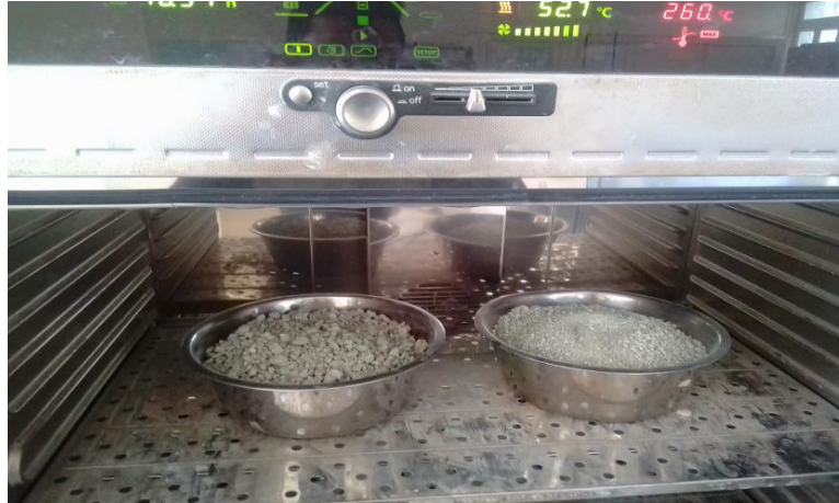
Figure II. 6: Etuve utilisée pour sécher la pouzzolane
