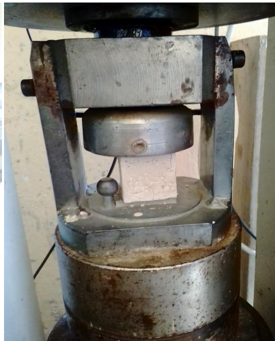
Figure II. 13 : Presse de compression à béton avec mécanisme spéciale pour échantillons cubiques 4 \times 4 \times 4 \text{ cm}^3 .
