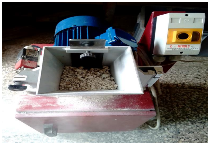
Figure II. 7 : Broyeur électrique utilisé
