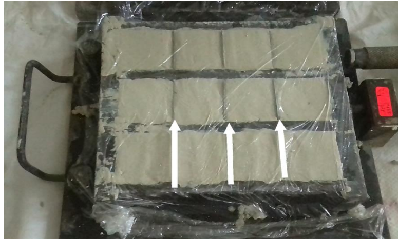
Figure II. 10 : Moule prismatique rempli de pâte, devisé par quatre.
