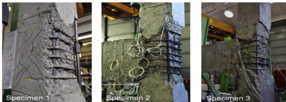
Figure II.36 : Spécimens pré endommagés de Flora Faleschini et al [68] .
