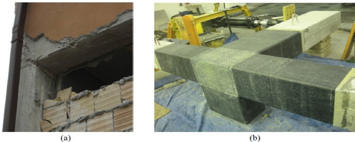
Figure II.27 : Cisaillement et renforcement de joint poteau-poutre ; Cisaillement de joint poteau-poutre Renforcement par des fibres PRF Ciro Del Vecchio et al [65] .
