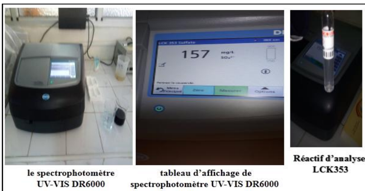
Figure 23. Le test en cuve LCK 353 sur le spectrophotomètre UV-VIS DR6000, effectué au laboratoire chimie du centre CNTC de Boumerdes.
