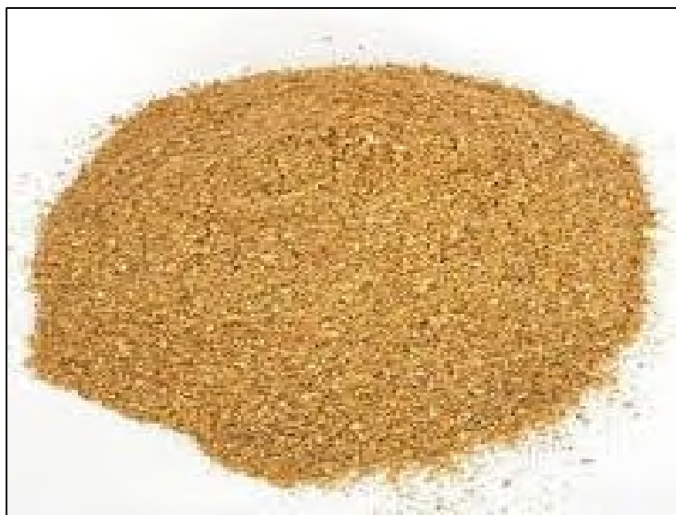
Figure 10 : Photographie de la poudre de coquille d'amande, obtenue après tamisage.
