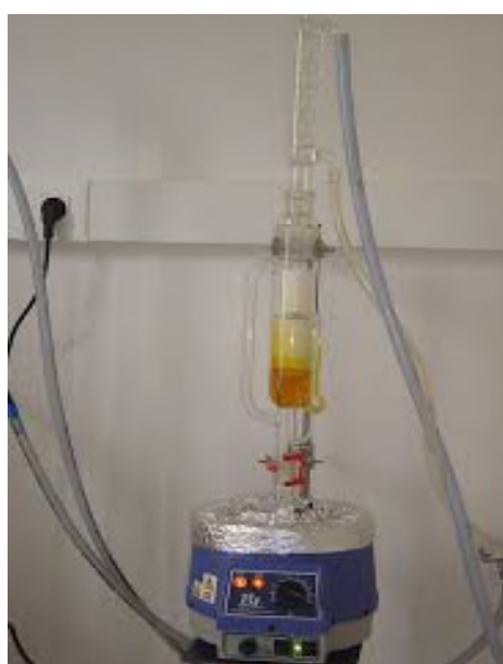
Figure 15 : Photographie de l'extraction de l'huile d'amande en utilisant le soxhlet.
