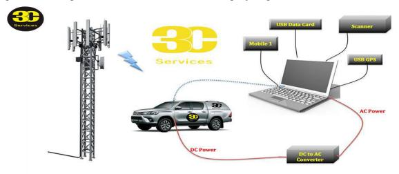
Figure II.3 - Drive test en 3G.
