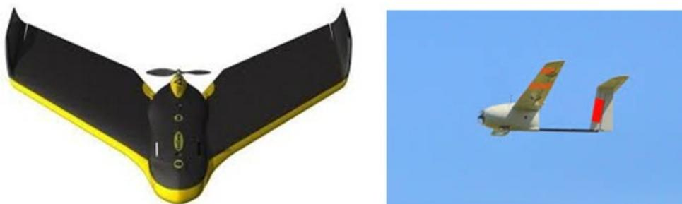
FIGURE 1.3 – L'aile volante eBee et Techpod
