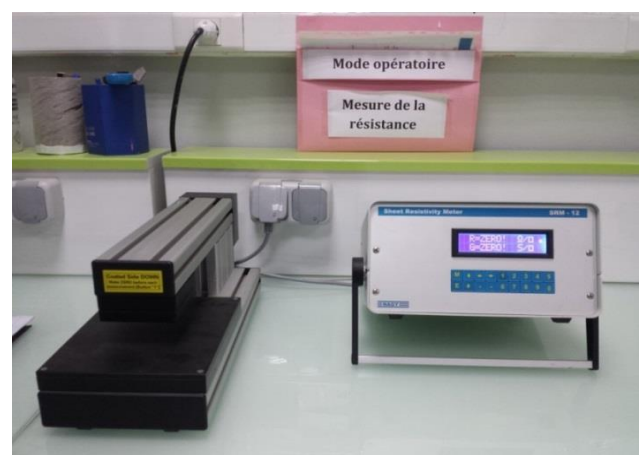
Figure III.7 : Dispositif expérimental de Résistivimètre (type SRM-12 Nagy) [17].
