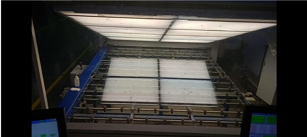
Figure III.3 : Observation visuelle de la feuille à la sortie du procédé de dépôt de couche [17].
