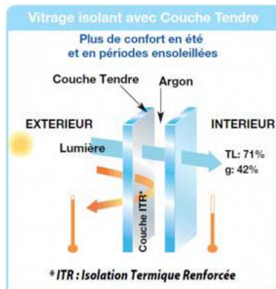
Figure II.8 : Fonctionnement optique du verre a couche [43].
