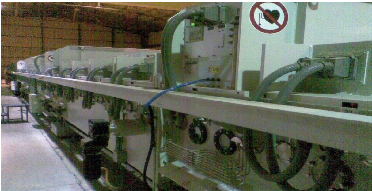
Figure IV.12 : Zone de la partie de pulvérisation cathodique [17].
