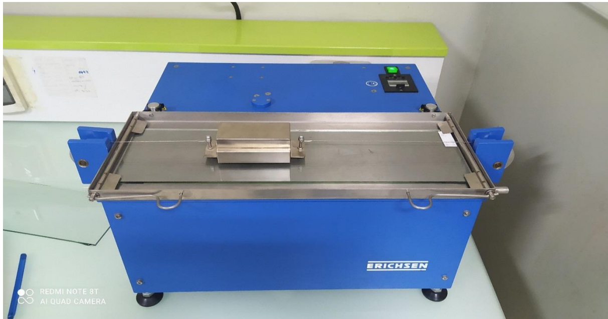
Figure III.9 : Appareil de contrôle de la dureté et de l'abrasion : Erichsen modèle 494 [17].
