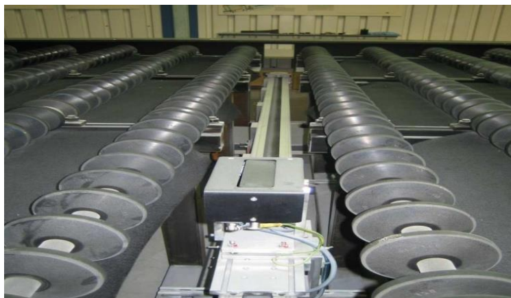
Figure III.1 : Mesure des spectres de réflexion du verre [17].
