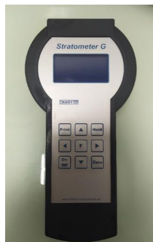
Figure III.5 : Stratometer G (Appareil de mesure de la résistivité) [17].
