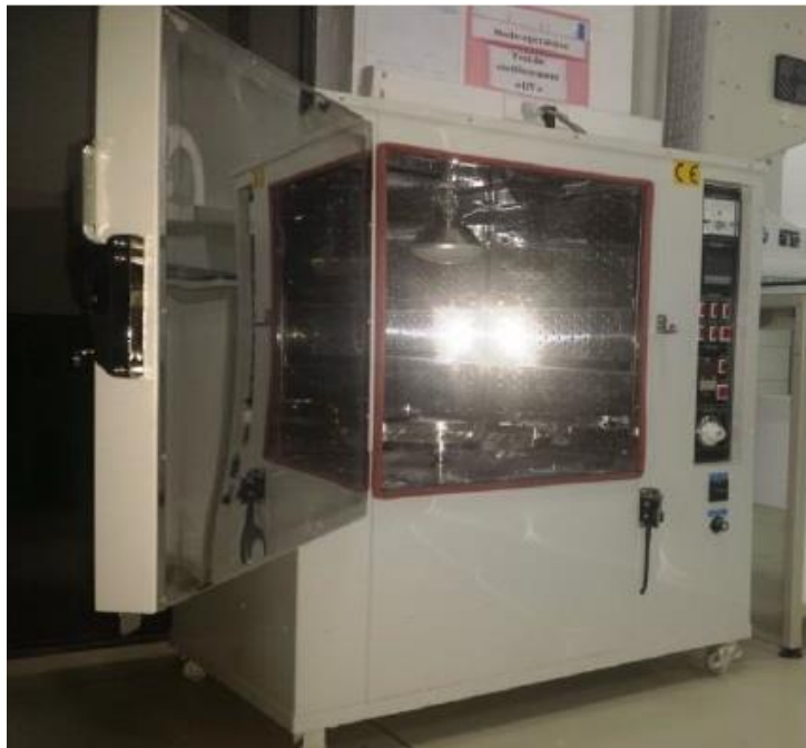
Figure III.16 : Dispositif expérimental de test de Vieillessement « UV » [17].
