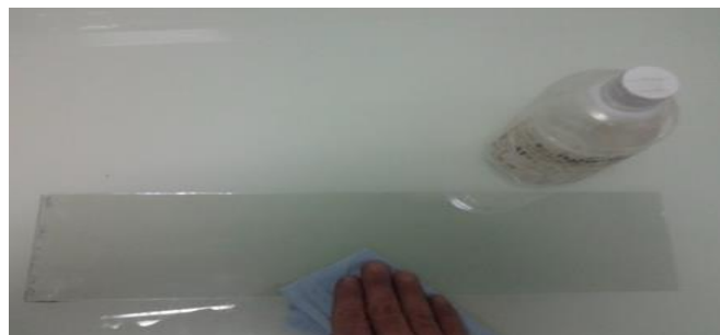
Figure III.13 : Test d'essuyage humide [17].
