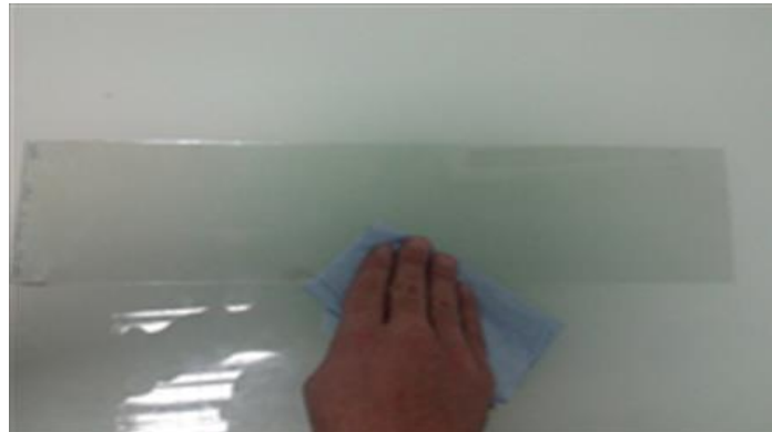
Figure III.12 : Test d'essuyage à sec [17].
