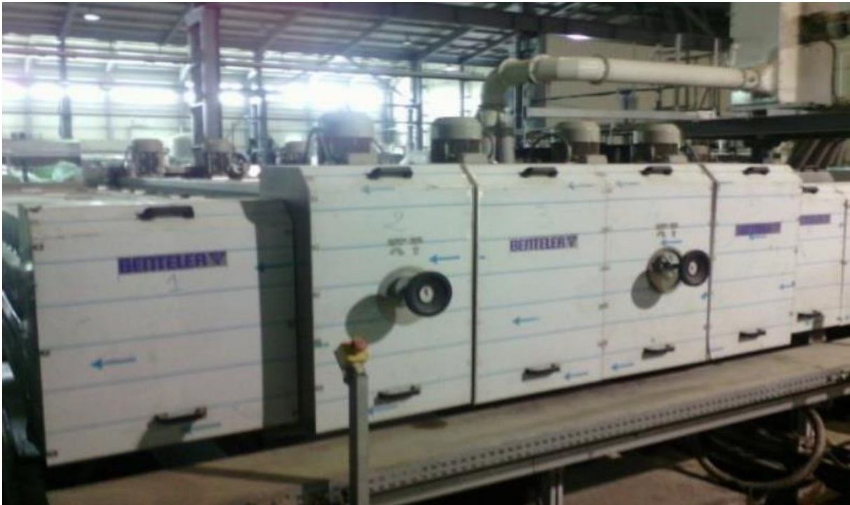
Figure IV.9 : Dispositif de la machine à laver et du séchoir [17].
