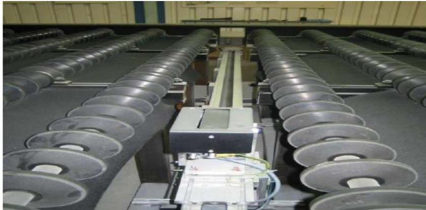
Figure IV.14 : Mesure des spectres de réflexion du verre [17].
