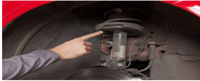
Figure I.11 Aperçu d'un amortisseur monté sur une roue
