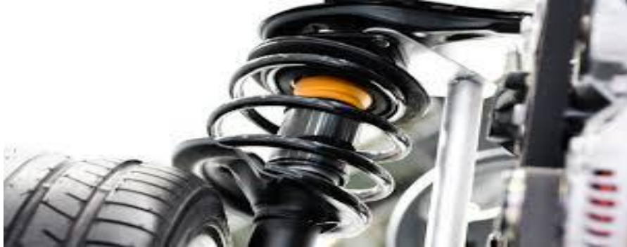
Figure I.9 Exemple d'un ressort à spirale cylindrique
