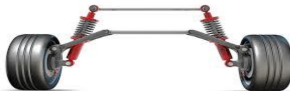
Figure I.2 Exemple d'un système de suspension active
