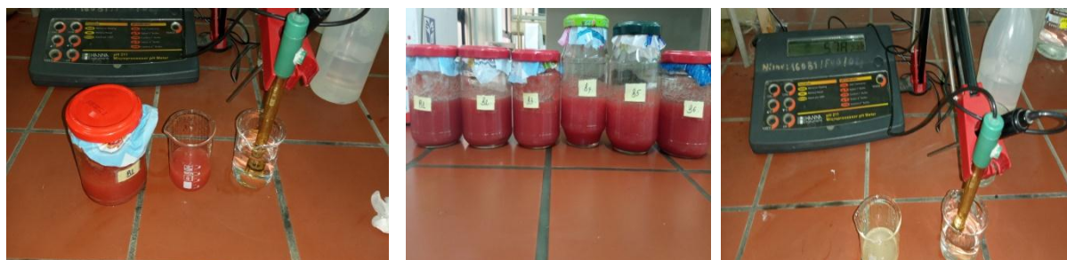
Figure 54 : mesure de pH d'un jus de tomate et d'un jus de citron pur.
