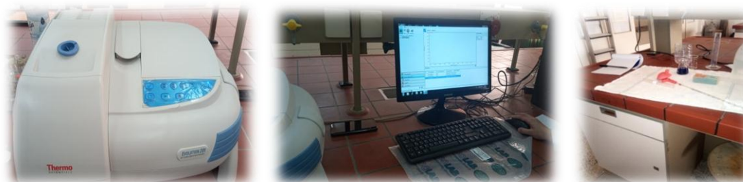
Figure 60 : Dosage de la solution par le DCPIP et mesure de l'absorbance.
