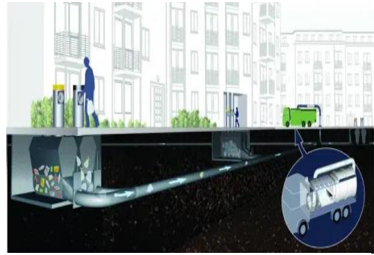
Figure 17 : Système souterrain d'évacuation des déchets ménager
