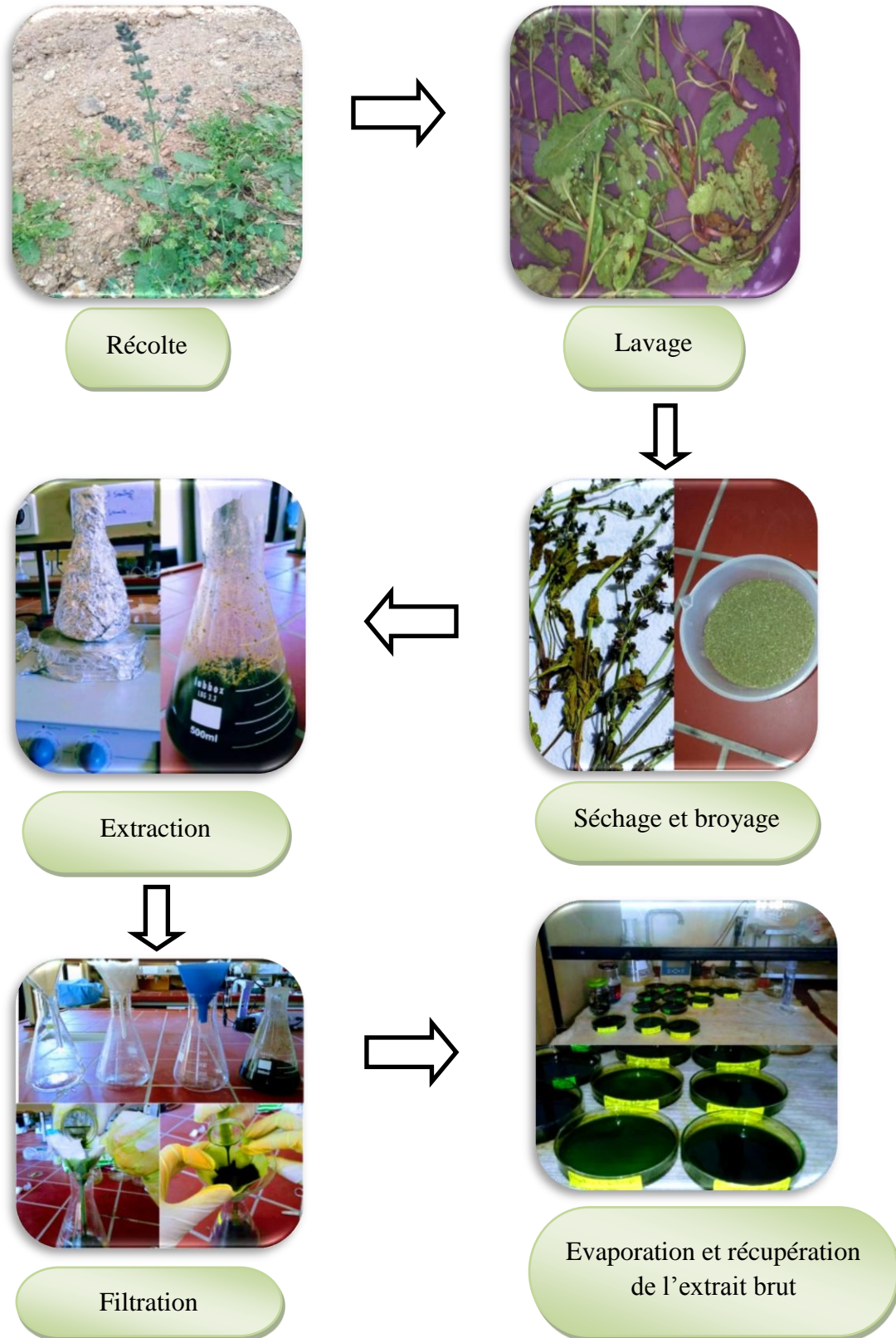
Figure 09: Protocol expérimental d'extraction des composés phénoliques des parties aériennes de S. verbenaca (Kostić et al. , 2015).
