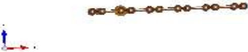
Figure 3-6 : Structure relaxée du graphène dopé avec un atome de fer (Plan OYZ)
