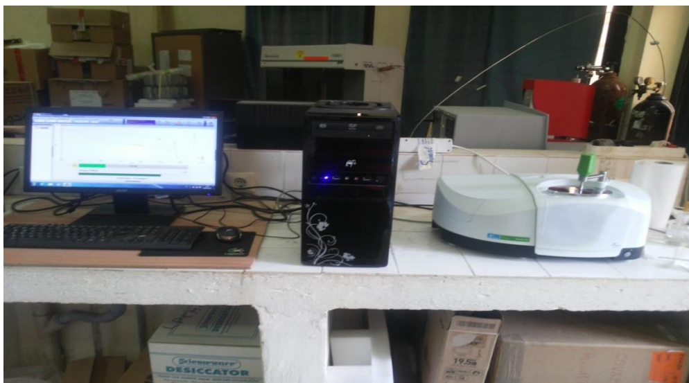
Figure II.9 : Image du spectrophotomètre infrarouge à transformé de Fourier (FT-IR)
