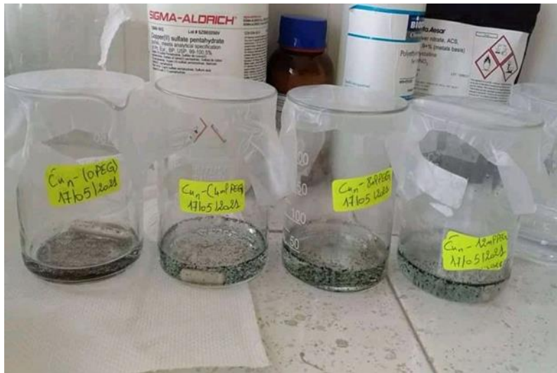
Figure II.4 : Solution contenant des nanoparticules de Cu synthétisée à des concentrations différentes d’PEG.
