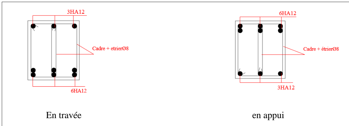
Figure 42 : schéma de ferrailage de la poutres secondaires 4 eme , 5 eme étages.
