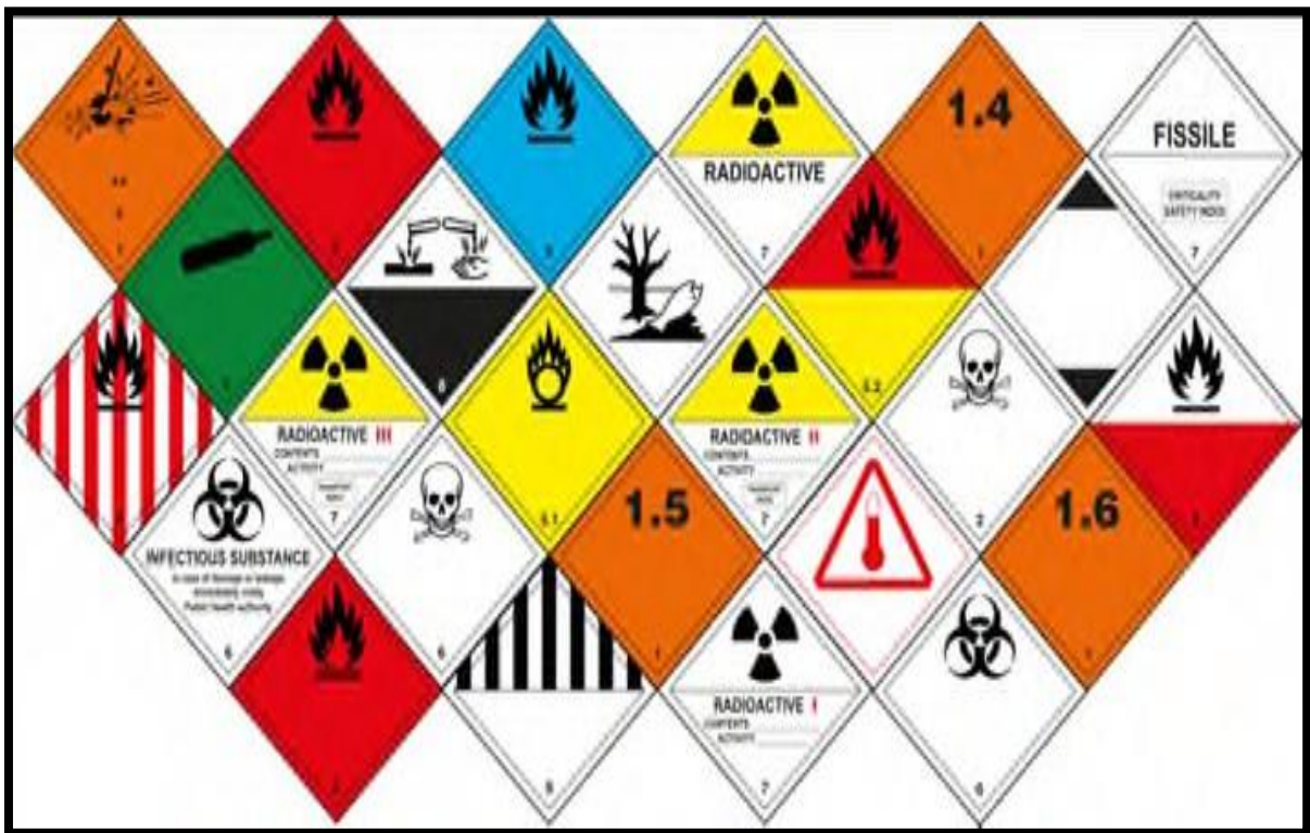
Figure 4 : Le marquage des conteneurs pour la marchandise dangereuse
