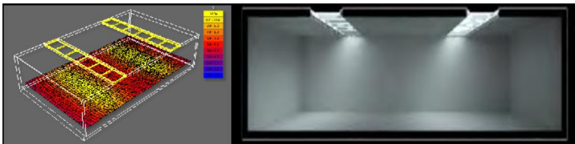
Figure I-23 : Éclairage zénithal directe (Source : Benharkat, 2006)
