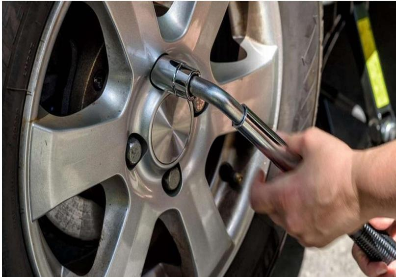
**Figure I.18.** Serrage des boulons.[11]
