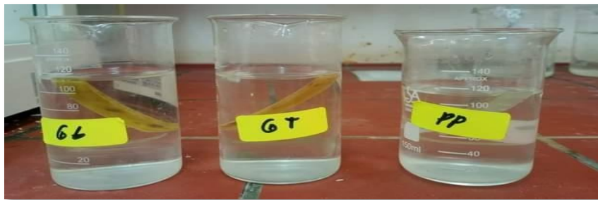
Figure II.9 : Etapes Pour déterminer Taux d'absorption d'eau de la fibre Genêt d'Espagne
