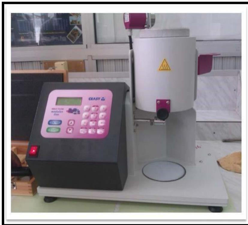
Figure IV.8 : Appareillage de mesure de l'indice de fluidité.
