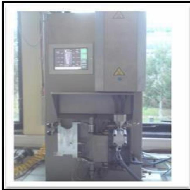
**Figure IV.5 :**Photo de la mini extrudeuse bis-vis co-rotative
