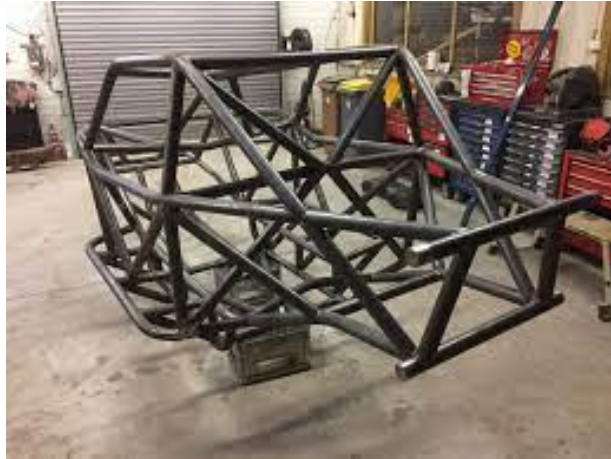
Figure I-8 Châssis tubulaire en acier. [17]
