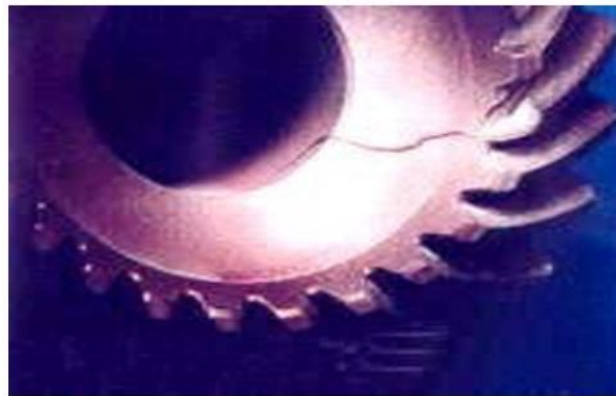
Figure 1.5 défaut de fissuration
