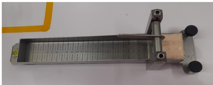
Figure 6 : L'écoulement par le consistomètre de Bostwick.
