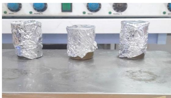
**Figure 8.** Extraction conventionnelle des CPT sur plaque agitatrice.
