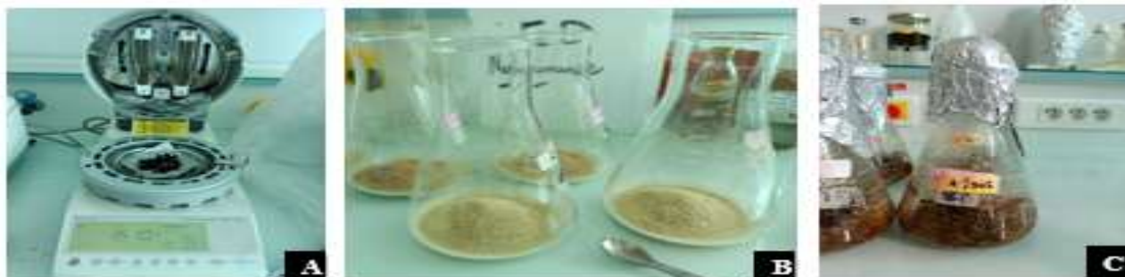
Figure 7 : photographie des étapes de fermentation solide, A ; Détermination d'humidité à l'aide d'un dessiccateur infrarouge, B ; Substrat paille/son de blé dans des Erlen de 500mL à col large et C ; Cultures de fermentation solide après stérilisation.
