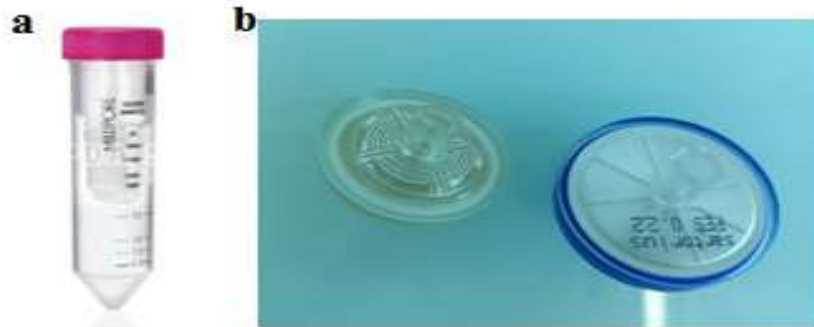
Figure 8 : Photographie de l'Amicon Ultra-15 3kDa (a) et les filtres de stérilisation (b)
