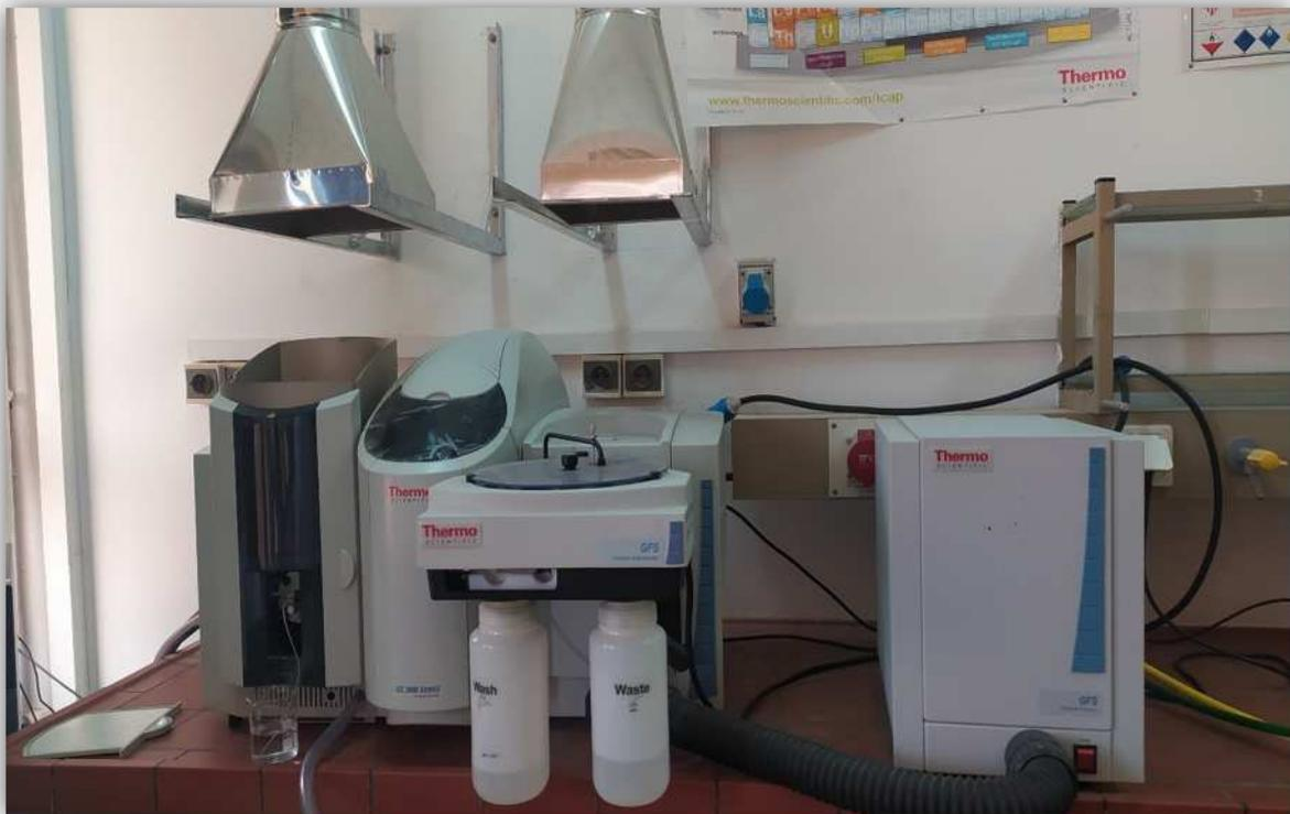
**Figure 25 :** Spectromètre d'absorption atomique.
