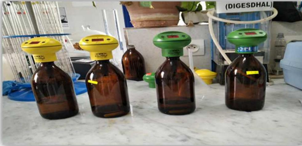
**Figure 20 :** Echantillons pris pour la DBO<sub>5</sub>\*
