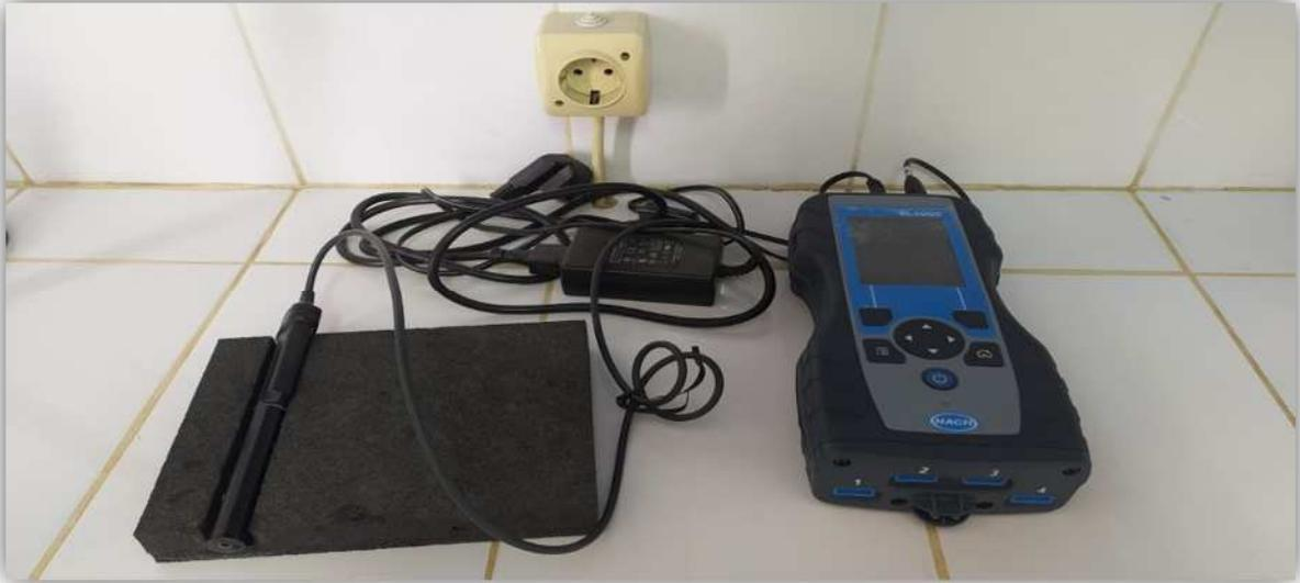
**Figure 12 :** Conductimètre.
