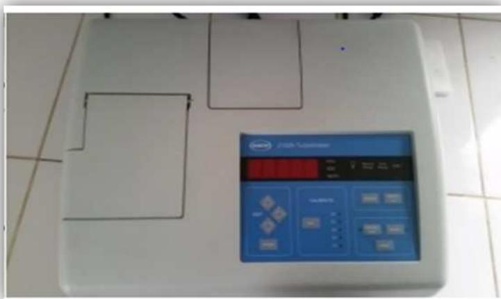
**Figure 13 :** Turbidimètre HACH 2100N (Laboratoire de l'ADE).
