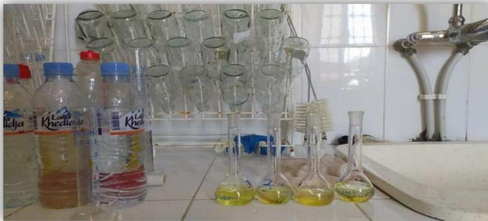
**Figure 23 :** Echantillons pris pour  $\text{NO}_3^-$ .
