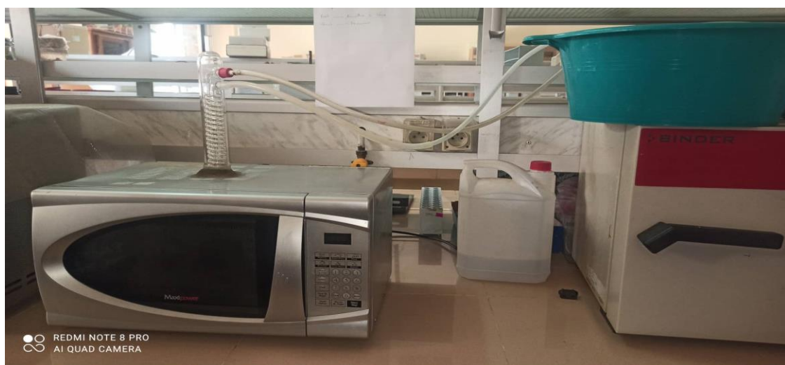
Figure (11) : Microonde utilisée pour l'extraction des extraits phénoliques
