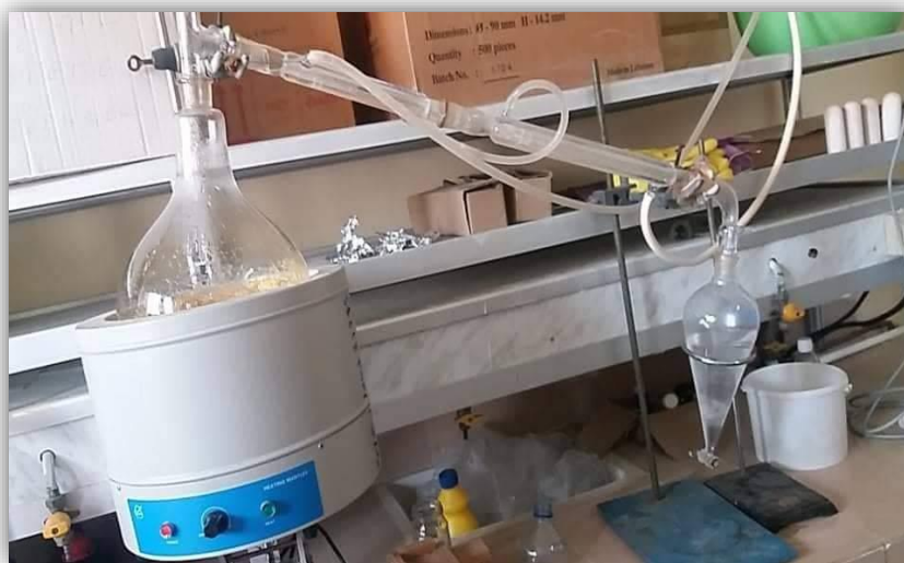
Figure (10) : Extraction des huiles essentielles par Hydrodistillation
