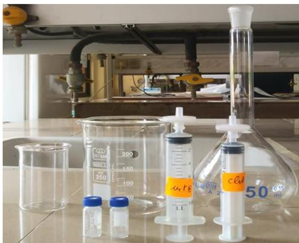
**Figure N°12** : matériels utilisés dans la préparation de la phase mobile HPLC.
