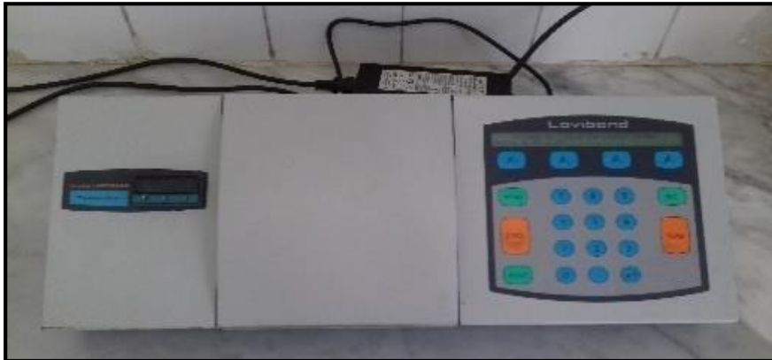
Figure n° 12. Appareil de mesure colorimétrique « Lovibond ».
