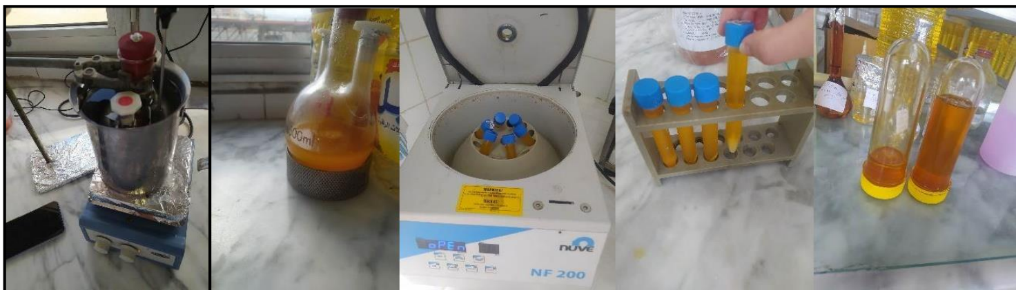
Figure n° 13. Etapes de dégommage enzymatique à échelle de laboratoire.
