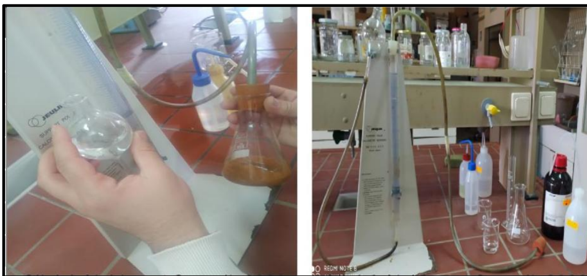
Figure n°06 : Etapes de dosage du calcaire totale dans le sol ( Photographie originale, 2023 ).
