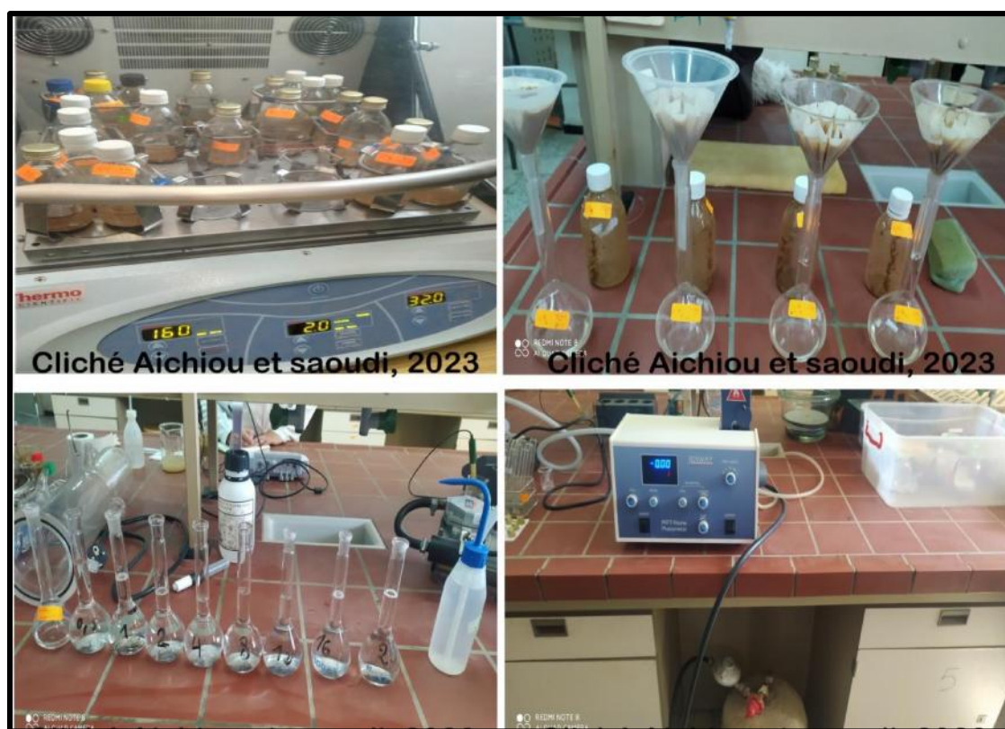
Figure n°08 : Etapes de dosage du Potassium Assimilable ( k ) et du Sodium ( Na ) dans les échantillons du sol ( Photographie originale, 2023 ).
