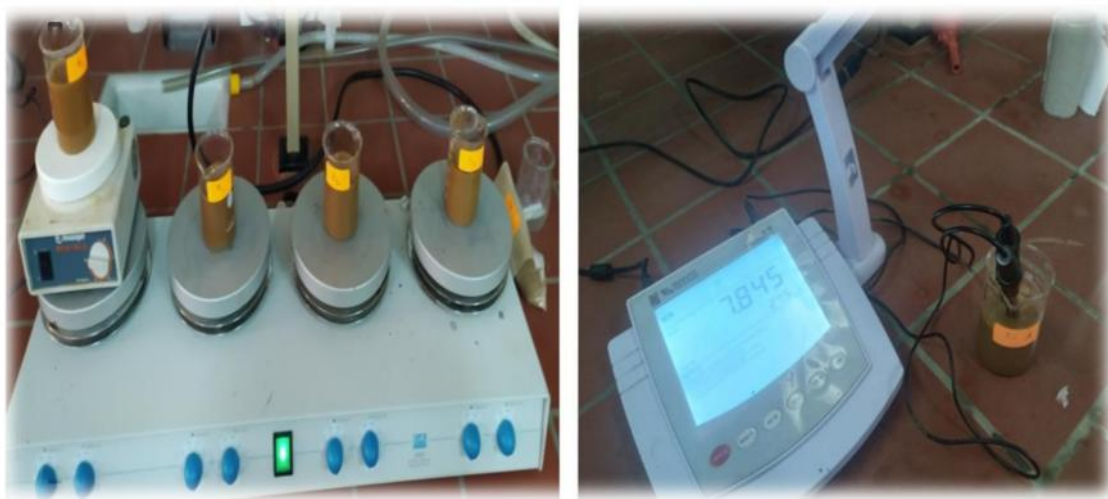
Figure n°04 : Etapes de mesures du pH (eau) dans le sol (Photographie originale, 2023).
