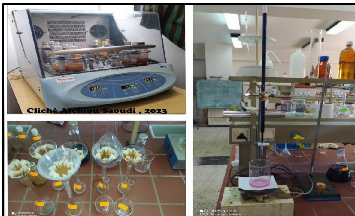
Figure n°07 : Etapes de dosage du calcaire actif dans les échantillons du sol ( Photographie originale, 2023 ).
