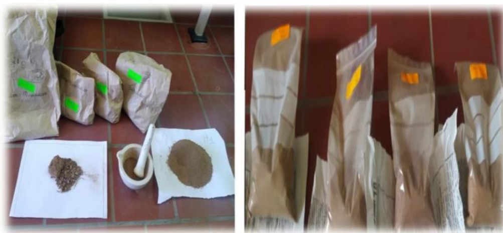
Figure n°03 : Préparation préalable des échantillons du sol (Photographie originale, 2023).
