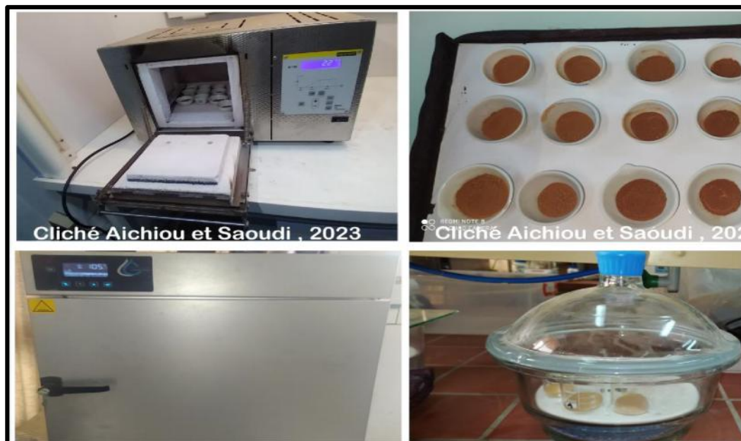
Figure n°10 : Etapes de dosage de la matière organique dans les échantillons du sol (Photographie originale, 2023).
