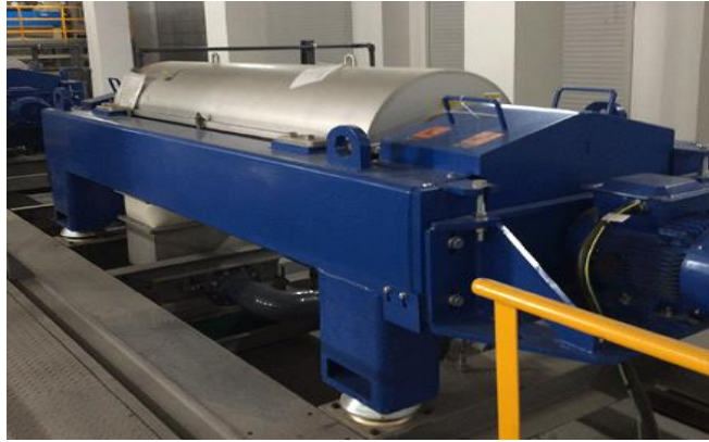
Figure N°08 : Séparation liquide / solide par centrifugation horizontale
