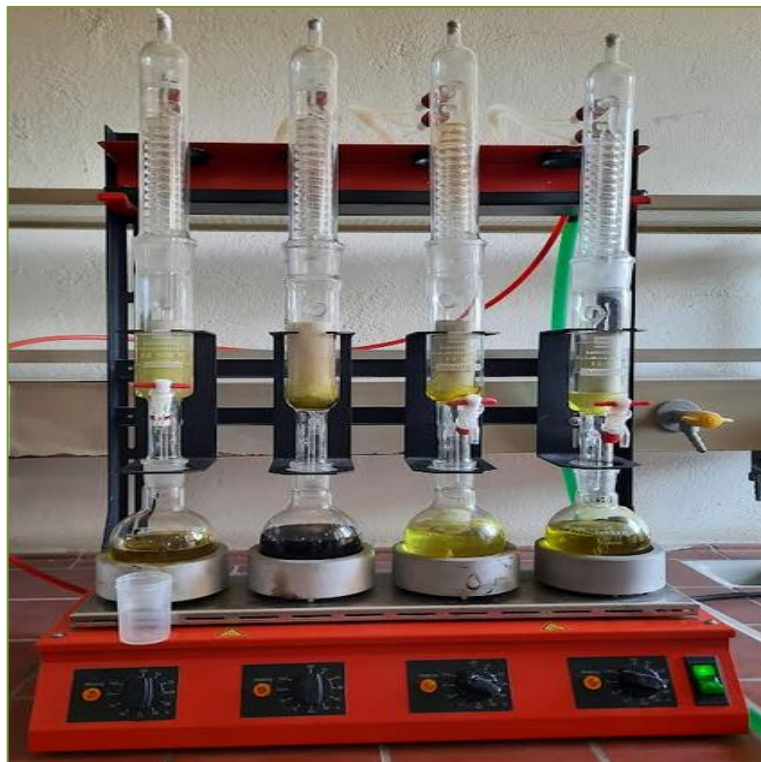
Figure 9 : Montage d'extraction liquide-solide « soxhlet » des huiles de lentisque ( Photo original )
