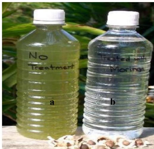
**Figure 3 :** Eau d'étang non traitée (a) et traitée (b) avec des graines de *Moringa* (Doerr et Staff 2005).
