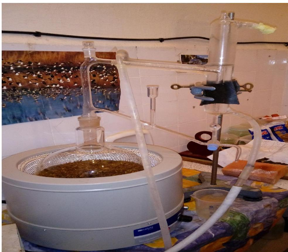
**Figure04:** Appareil dispositif d'extraction (Clevenger) des huiles essentielles.
