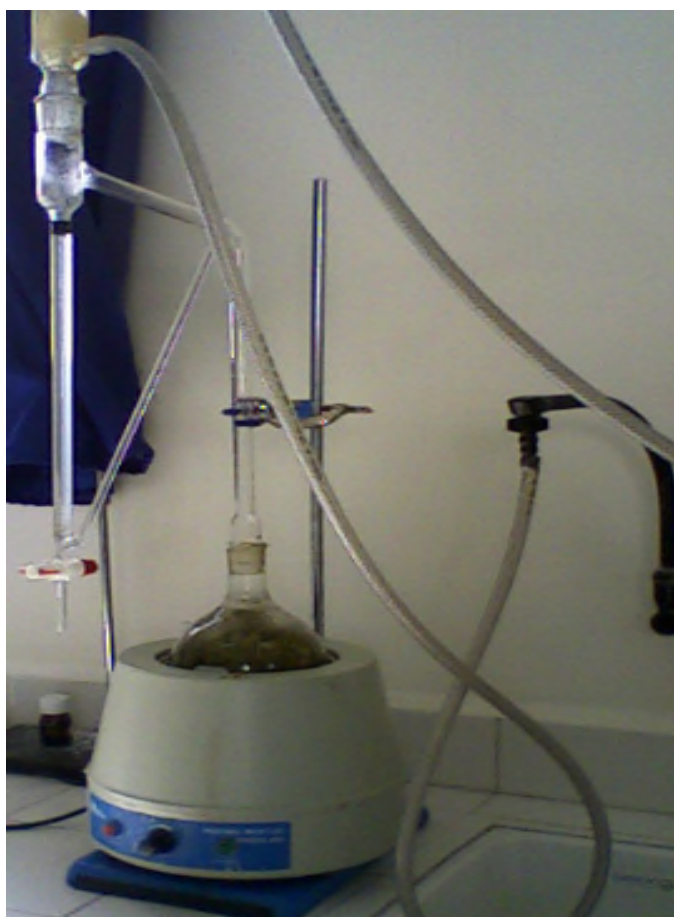
Figure 5 : Présentation de l'hydrodistillateur utilisé pour l'extraction des huiles essentielles.
