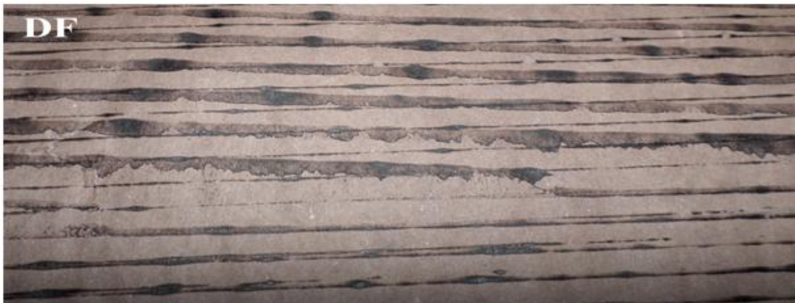
Figure III.8 : Dépôt de colle décalé et non uniforme sur la DF
