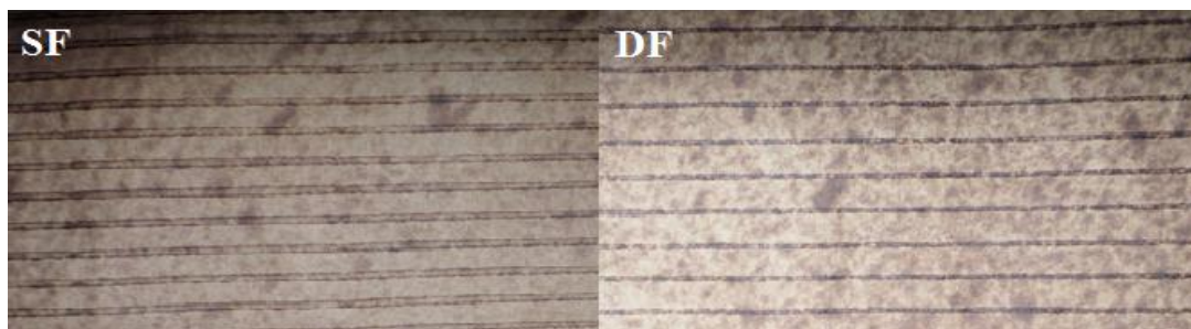
Figure III.2 : Manque du dépôt de colle sur la Simple et Double Face
