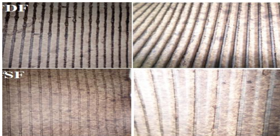
Figure III.11: Dépôt de colle en bordure
