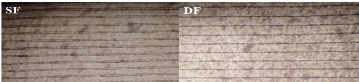
Figure III.6 : Manque de dépôt de colle sur simple et double face (SF/DF)
