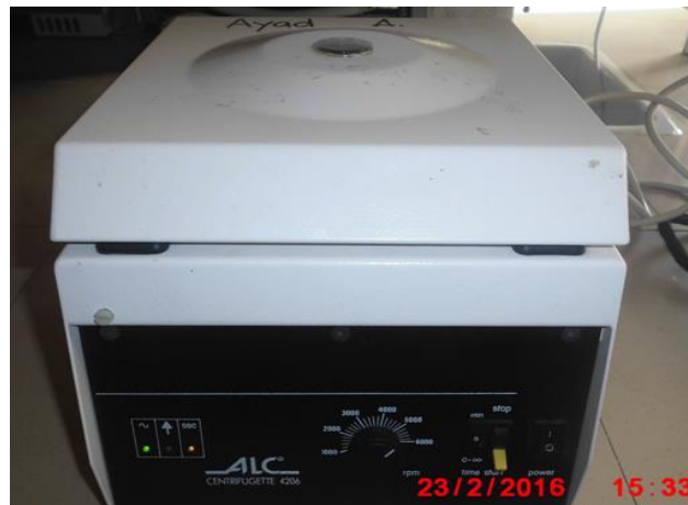
Figure n°10 : centrifugeuse de marque ALC centrifugette 4206
