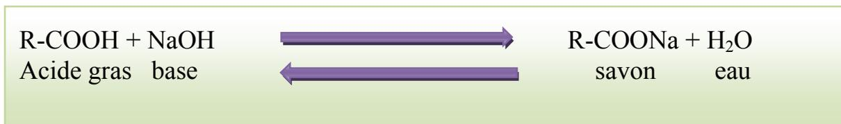
Il est possible de coupler démulcination et neutralisation. Dans ce cas, phospholipides et savons sont séparés en une seule étape de centrifugation. Les deux opérations sont effectuées en continu à 80°C environ (**Cossur et al, 2002**).
