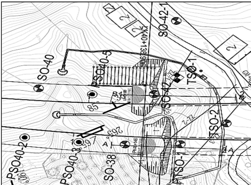
Figure II.9. Vue en plan des sondages carottés (SO) et prssiométriques (PSO).[19]
