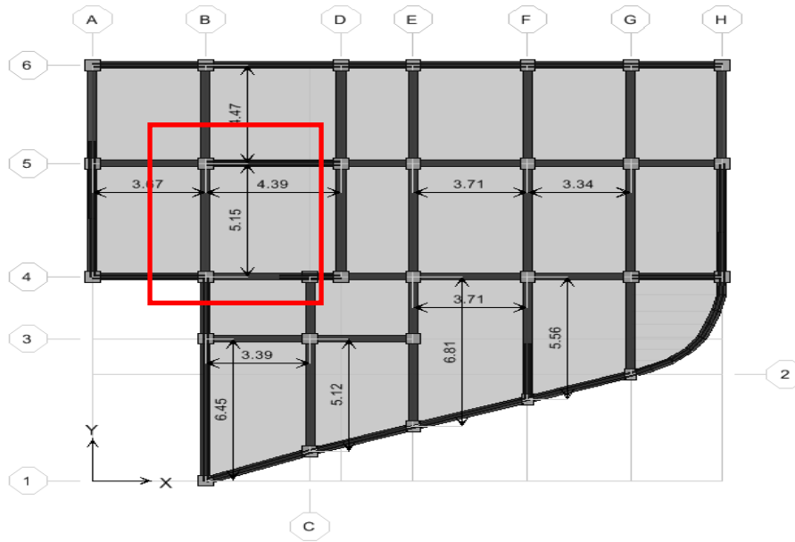
Figure.7.7. Panneaux de dalle du radier (e = 40cm)
