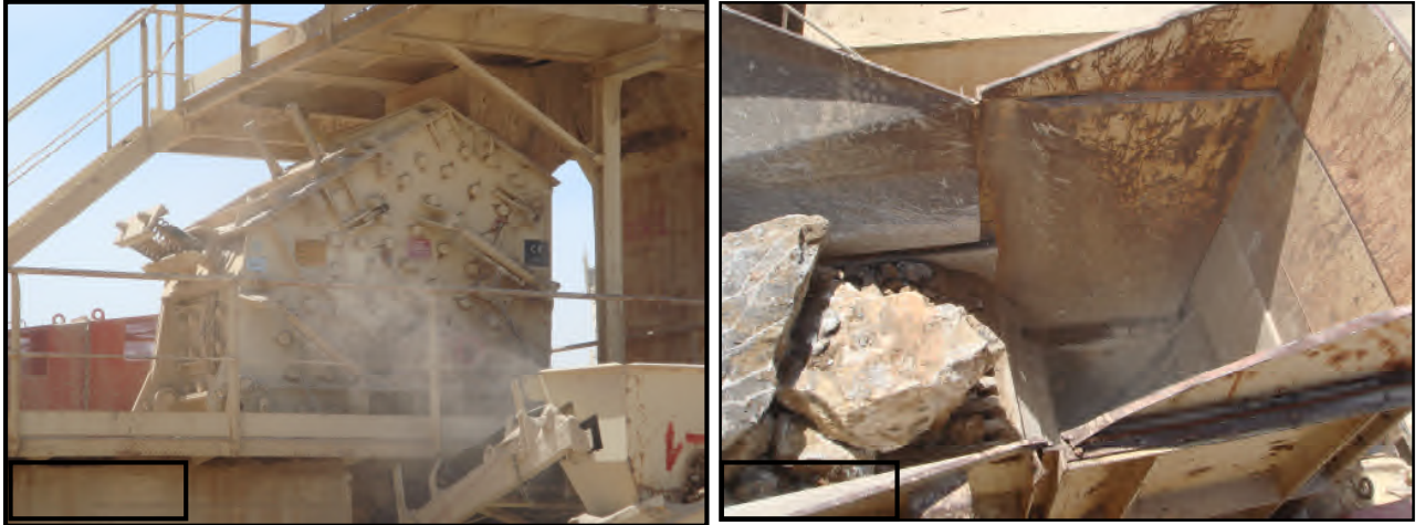
Photo I.16 et I.17. Photos illustrant le broyeur à percussion à gauche et le broyeur à mâchoire à droite utilisés dans le concassage des enrochements.
