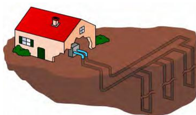
Figure II. 17: Exemple d'une très basse géothermie Source : BRGM
