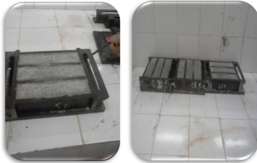
Figure II.8 : la conservation et le démoulage des éprouvettes
