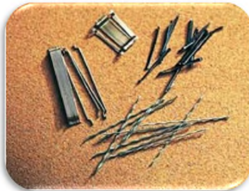
Figure II.1 : différents types de fibres métalliques [2]
