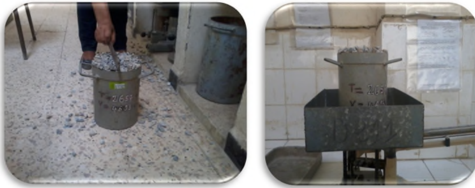
Figure I.8 : mesure de la masse volumique apparente
