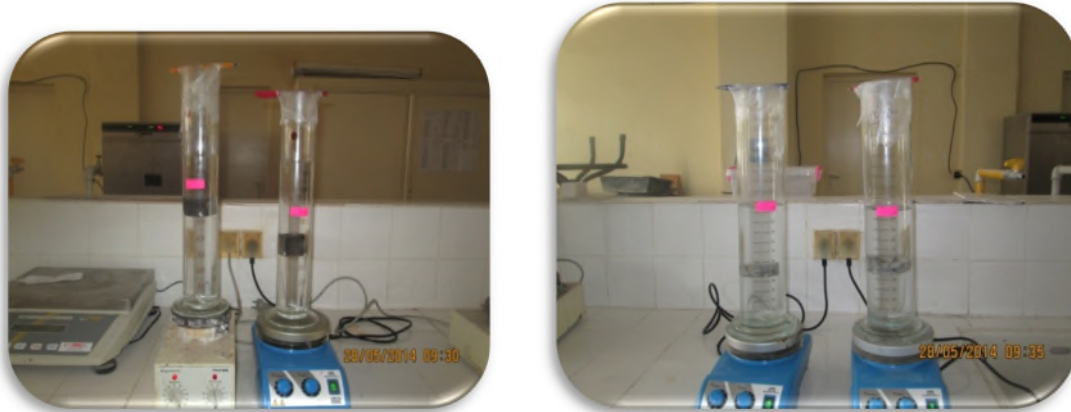
Figure III.13 : Test Lixiviation Monolithe de béton et mortier dans deux milieux
