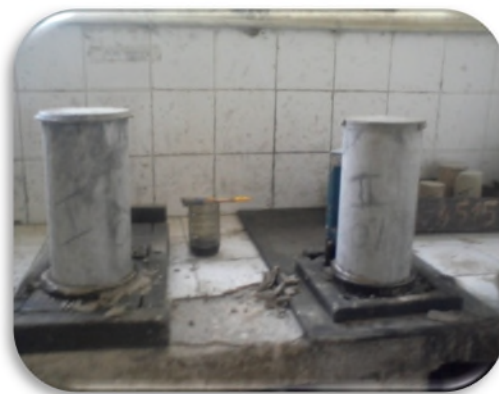
Figure III.9 Surfaçage des éprouvettes
