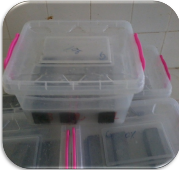
Figure II.9 : Conservation des éprouvettes du gonflement dans l'eau distillée.
