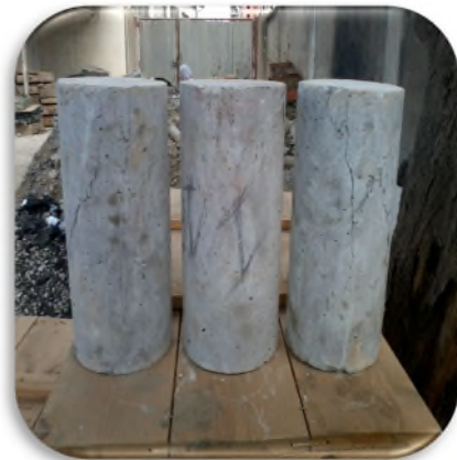
Figure III.11 : fissures des éprouvettes
