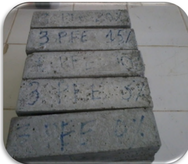
Figure II.10 : Conservation des éprouvettes pour le retrait à l'air libre
