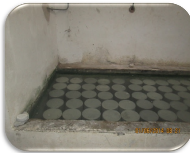
Figure III.8 Conservation des éprouvettes
