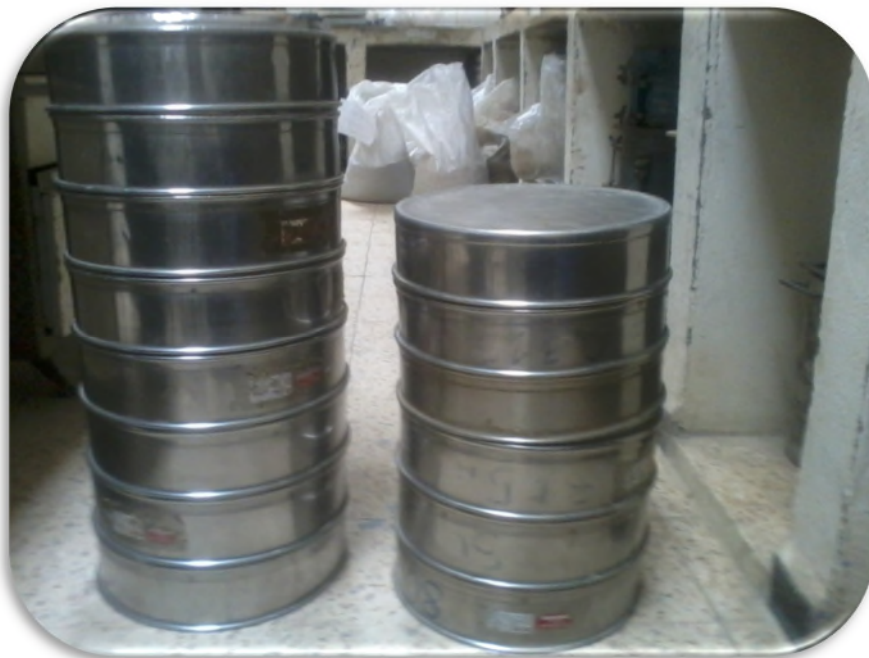
Figure I.2 : Colonnes de tamis
