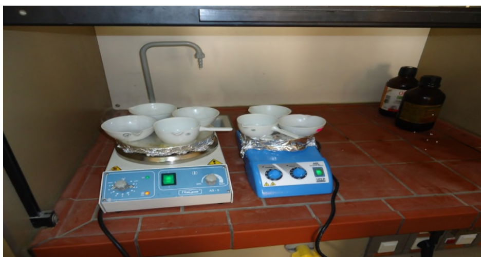
Fig.12 : Les cendres des différents miels traitées par l'acide nitrique sur une plaque chauffante sous la haute
