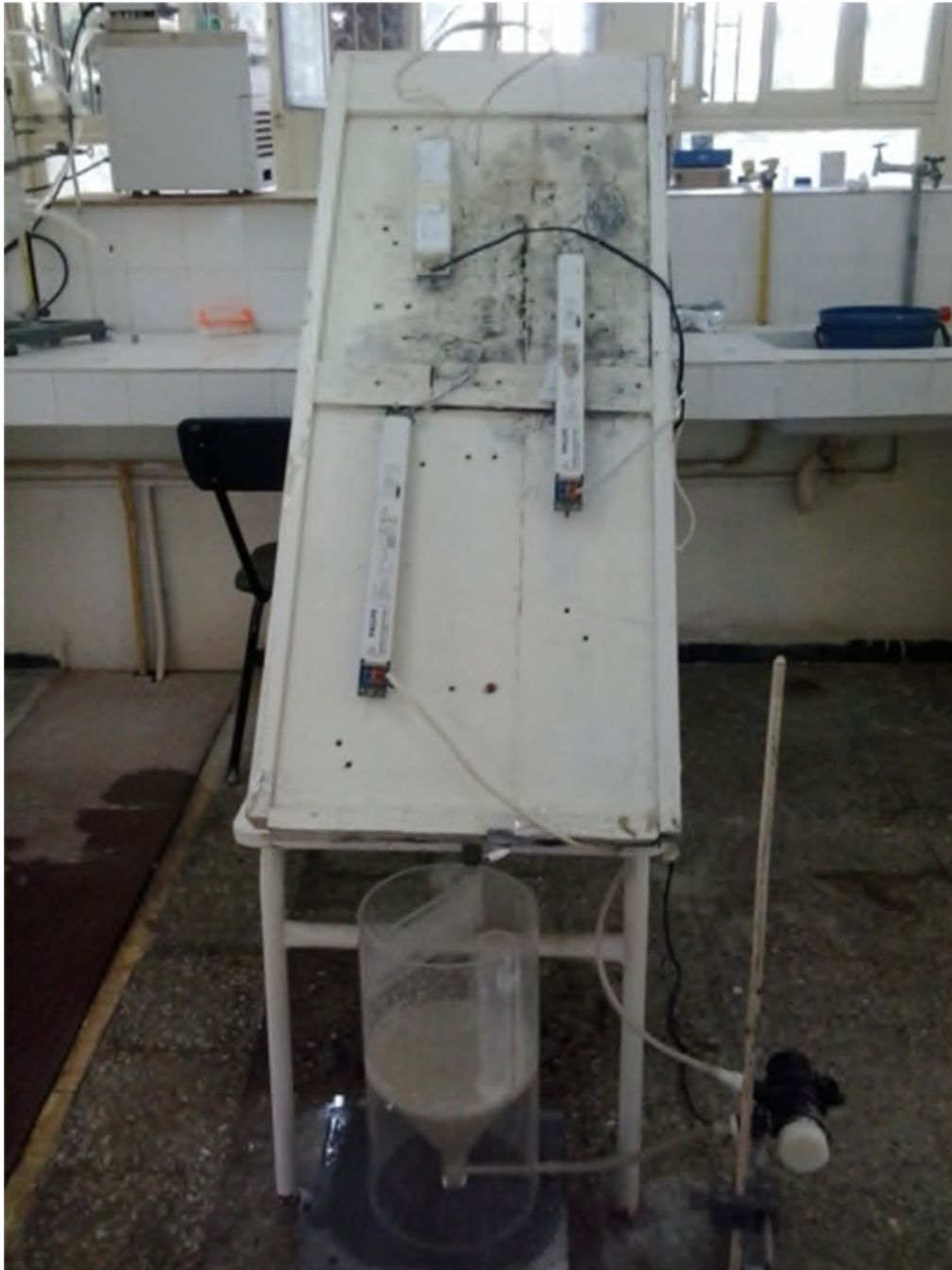
Figure IV.1. : Diapositif expérimental : réacteur en escalier.
