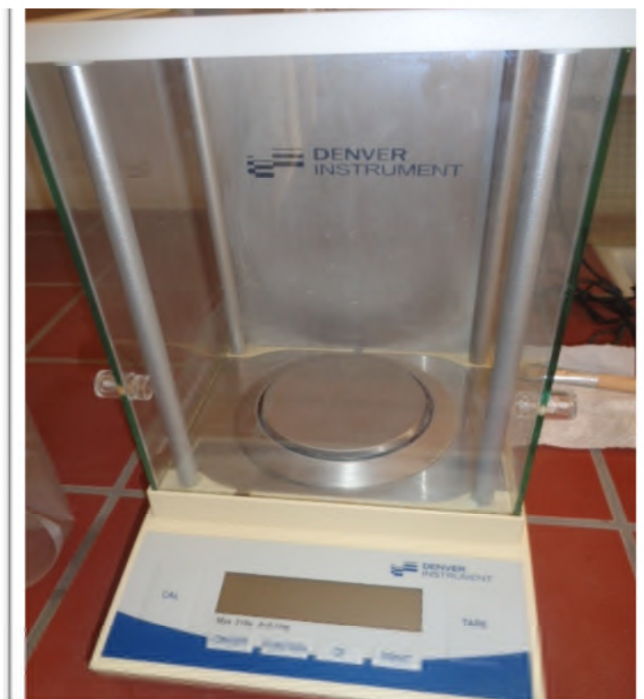
Balance analytique de précision \pm 0,1\text{mg}
